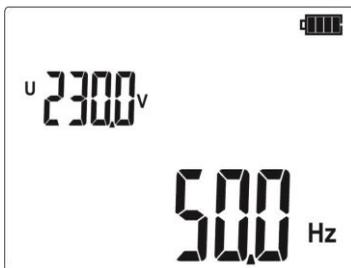
Leggi il risultato della misurazione: tensione sul campo del display ausiliario, frequenza sul campo del display principale.
